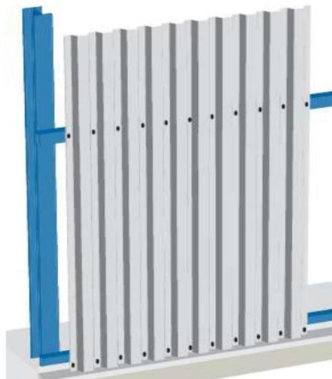
Figure 12 : Illustration de la fixation d'un bardage simple peau
